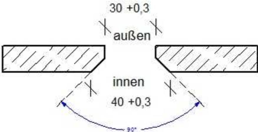
Bohrung 30 mm
